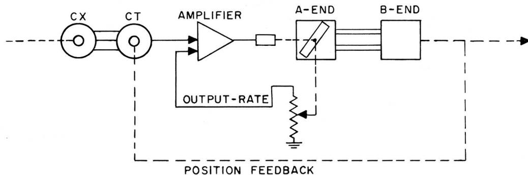
**B** VELOCITY FEEDBACK USING A POTENTIOMETER
